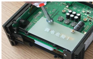
图 1.用工具拆开两颗螺母
