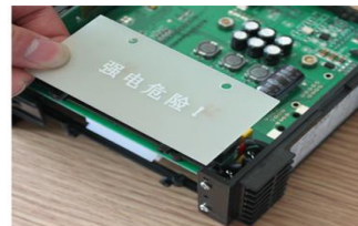
图 2.取下强电保护板
